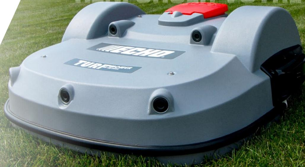
Turf Mower, en les amenant à une station de dépôt désignée. Les disques de protection en option sur les tondeuses évitent d'endommager les lames et les balles de golf, tandis que le poids léger de la tondeuse (moins de 160 livres) réduit le compactage du sol et des balles.
