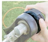
3. TOURNER LE DISQUE INFÉRIEUR POUR L'ENROULER
